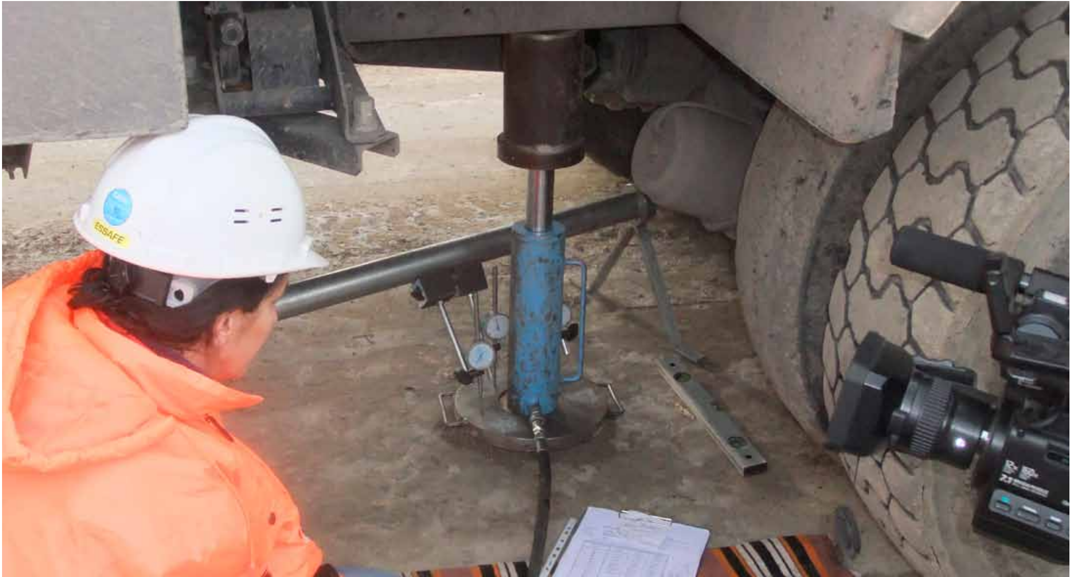
Ausführung eines Lastplattendruckversuchs
