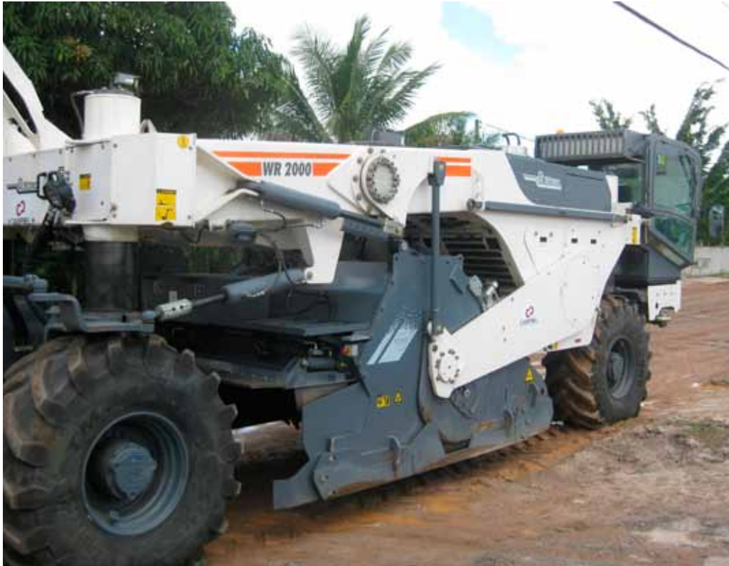
Einfräsen des Bindemittelgemischs auf eine Frästiefe von 0,30 m
