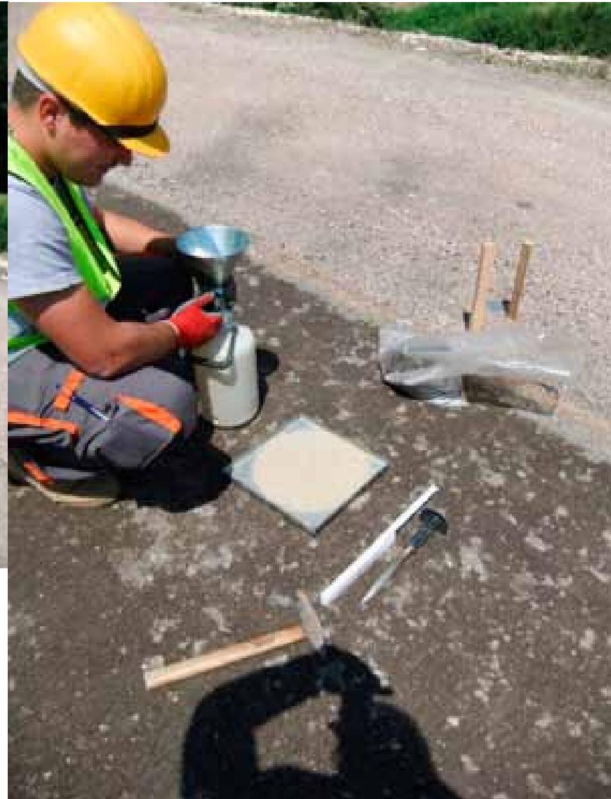
Kontrolle der Bodendichte durch das Sandersatzverfahren
