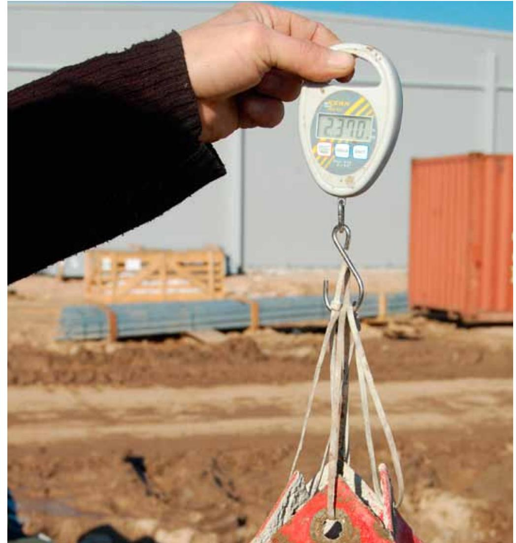
Netto-Menge NovoCrete® für diesen Abschnitt sind 1,3 kg/m<sup>2</sup> (bei 45 cm Frästiefe)
