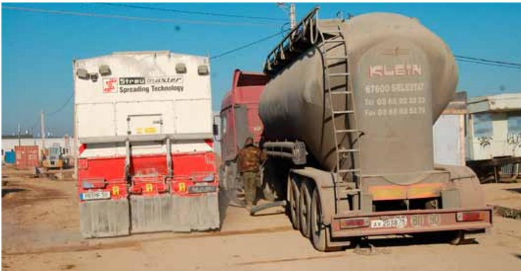
Befüllen des Streufahrzeuges mit Zement
